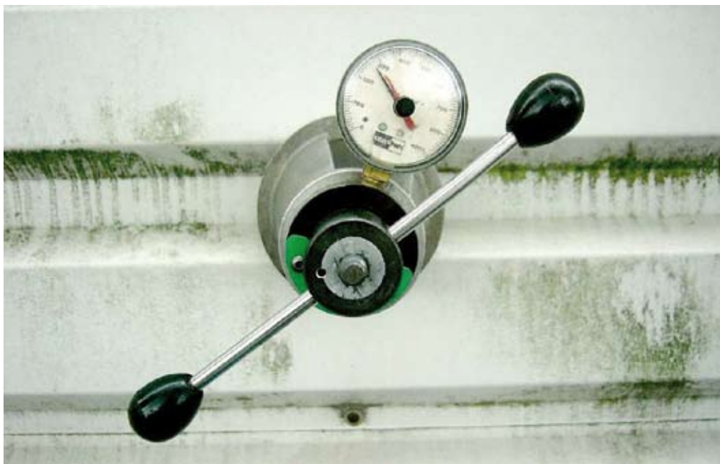
Tijdens het onderzoek is door middel van uittrekproeven de kwaliteit van meer dan 20 jaar oude bevestigers beoordeeld. De resultaten hiervan waren in het algemeen positief.
